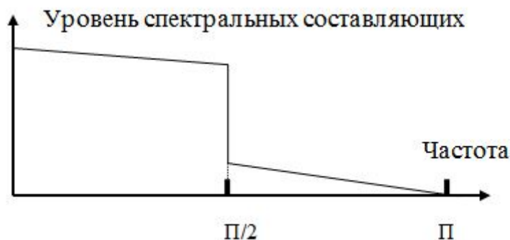
Рис. 2.10. Спектральное распределение шума на выходе детектора
